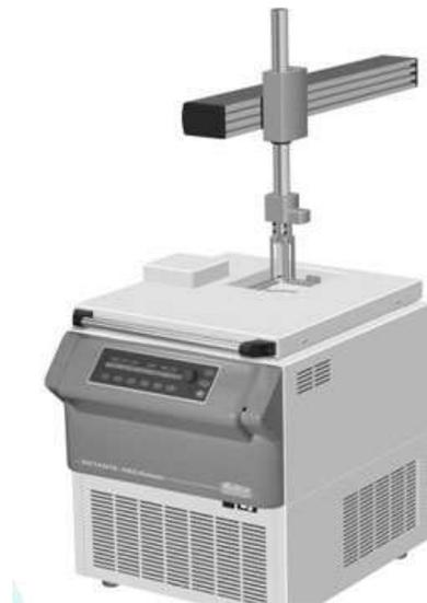
Максимальное относительное центробежное ускорение: 6446. Максимально об/мин: 6200 мин<sup>-1</sup>.
